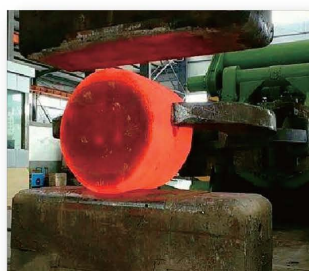
锻造材料机械锻打消除缺陷
